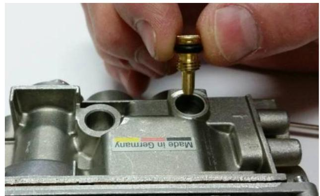
**Figure 23 – Enlèvement de la Vis de Basse Pression GN**
