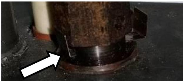
**Figure 27 – Dévisser la Tour et Glisser la Barrière de la Veilleuse Derrière la tour de la Veilleuse (en position GP)**
